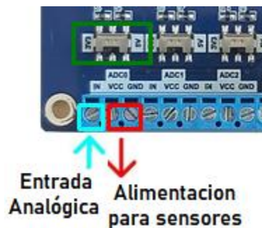
Figura 5. Entrada analógica y selector de voltaje
