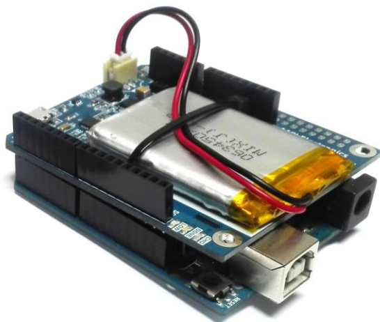
Figura 3. Montaje de UPS sobre Arduino.
